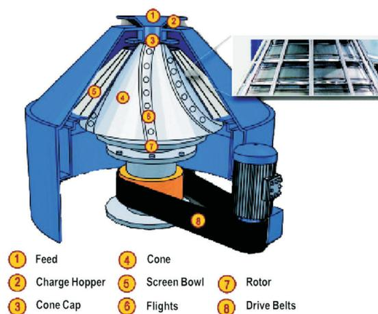
O Secador VORTEX reduz e recupera fluidos de base presentes em uma variedade de lamas. Em operações de perfuração, as peneiras vibratórias podem descartar cascalhos de perfuração cujo peso representa até 20% de óleo. O tratamento com o Secador VORTEX provou reduzir drasticamente este teor de óleo, em alguns casos a menos de 2%.
