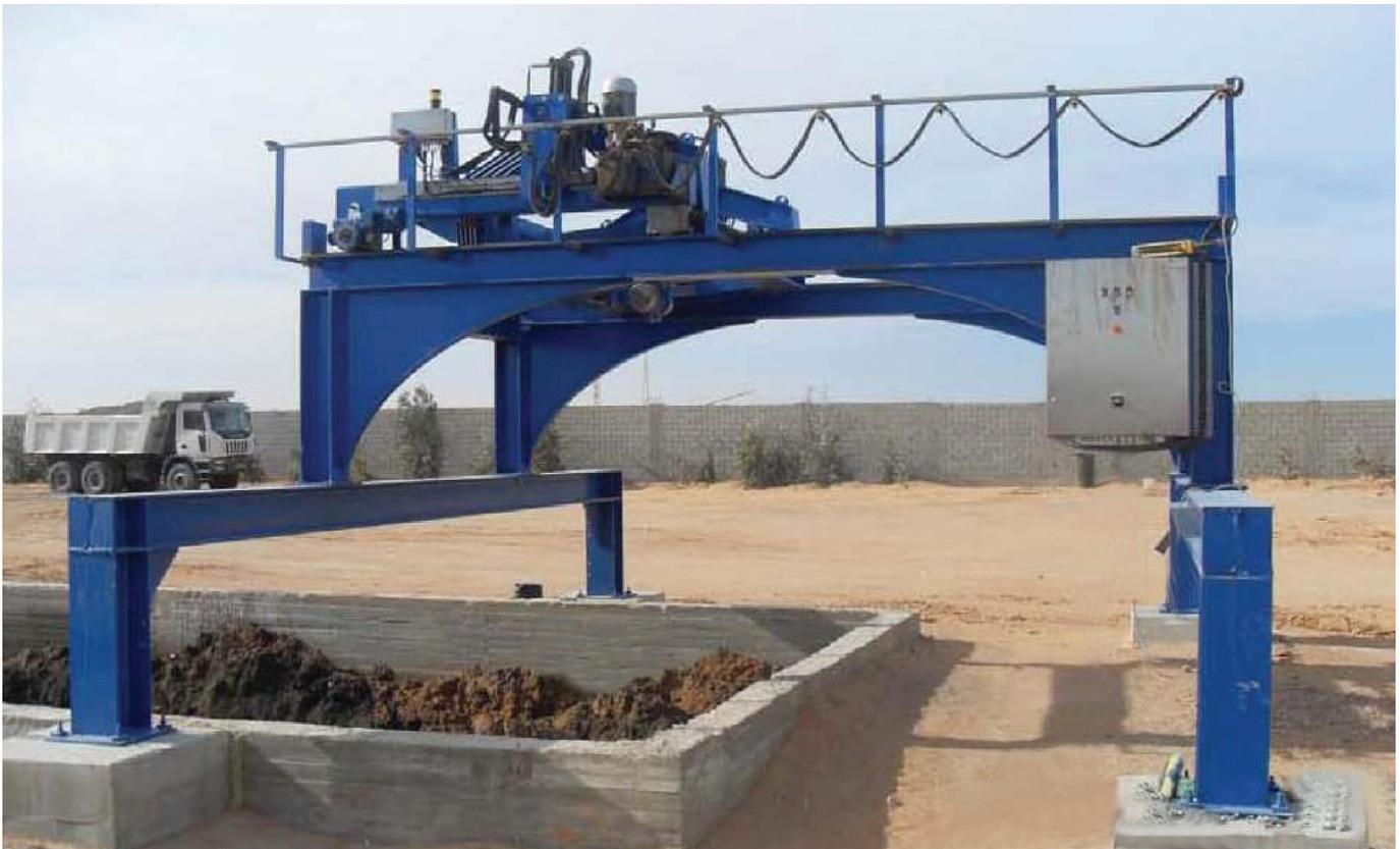
Girador de piletas de recortes instalado en la parte superior del tanque de lodo «en tierra»
