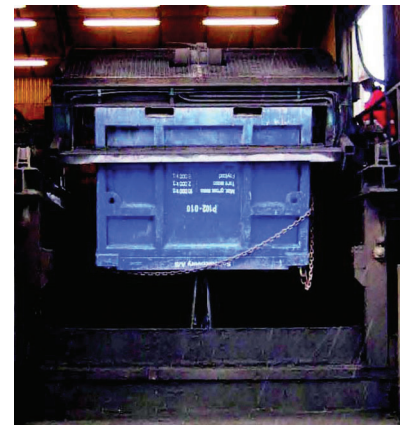
Le mouvement vibratoire assure l'évacuation complète des déblais de la benne
