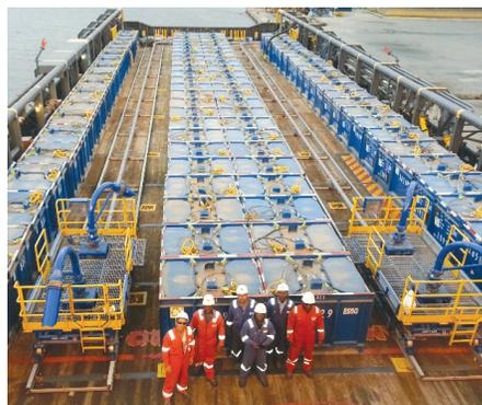
A solução de contenção e transferência de cascalho FluidControl permitiu o gerenciamento seguro, eficiente e efetivo dos resíduos de perfuração de nossos clientes à medida que eles migravam para uma aplicação de perfuração offshore de descarga zero.
