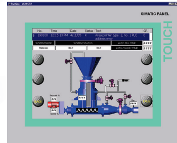
Pantalla del panel de control del sistema
