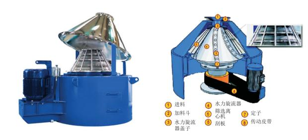
VORTEX干燥机减少和回收各类滤浆的基液。在钻进操作中,振动筛可以抛弃达到20%油重的钻屑。经证实,VORTEX干燥机可以将含油量 迅速降低,有些情况下可以降到2%以下。
