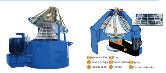
El secador VORTEX reduce y recupera el fluido base de una variedad de lechadas de carga. En las operaciones de perforación, las zarandas pueden descartar los recortes perforados que tienen hasta un 20 % de aceite por peso. Se ha demostrado que el tratamiento con el secador VORTEX reduce notablemente el contenido de aceite, en algunos casos a valores inferiores al 2 %. Beneficios adicionales:
