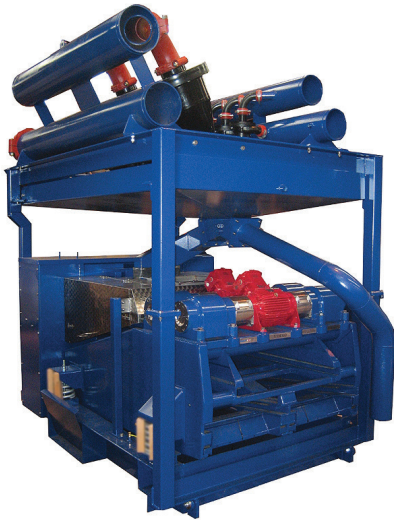
Zaranda VSM 300™ con colector acondicionador de lodo
