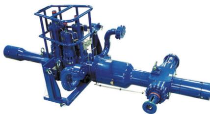
Поверхностная испытательная фонтанная арматура 6 3/4" API, 15 000 фунт/кв.дюйм
