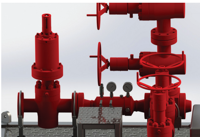
Colector múltiple de obturación que se muestra con la válvula ESD y las pestañas de información instaladas en el mismo patín.
