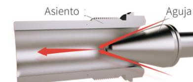
**4) Asiento Positivo**– Este recorte tiene un tamaño de orificio establecido que no se puede ajustar externamente. Para cambiar el tamaño del orificio, se debe extraer el asiento del cuerpo y debe ser reemplazado por un asiento con un tamaño de orificio diferente. También hay una versión de jaula del asiento positivo disponible para servicio severo.
