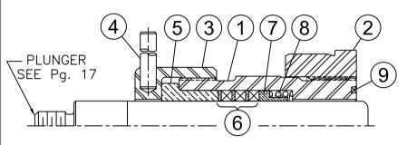
80T-3M (1 3/8" THRU 1 3/4" PLG'R) PLUNGER KIT WITH THREADED PLUNGER
