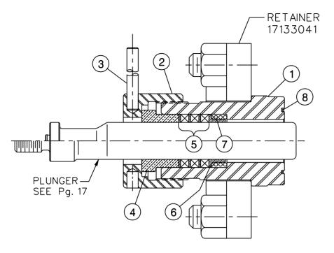
250T- 5H 21/4" PLUNGER KIT WITH CLAMPED OR THREADED PLUNGER
