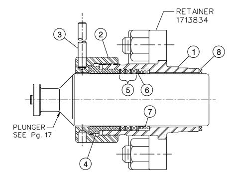
250T- 5L PLUNGER KIT WITH CLAMPED PLUNGER
